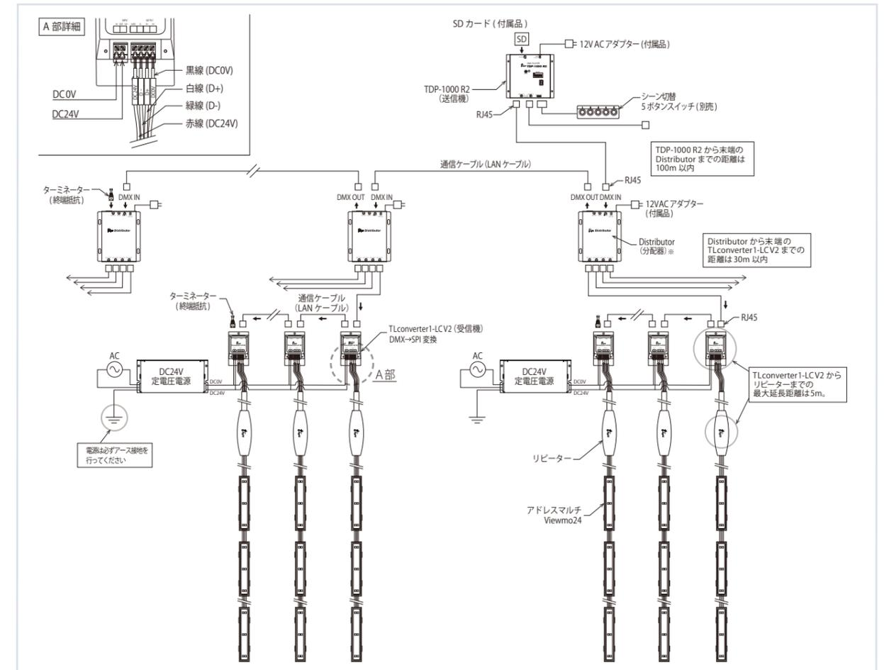
※ 1系統あたり通信ケーブル32台まで(送信機・分配器・受信機含めた台数)。32台以上の連結はDistributor(DMX4分配器)を使用。但しこの時Distributorも連結数の1台と数える。送信機から受信機の末端迄の距離が30mを超える場合もDistributorを使用してください(現場環境により異なる)。末端には、必ずターミネーター(終端抵抗)が必要となります(付属品)。
