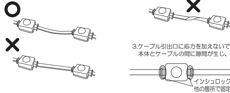
3. ケーブル引出口に応力を加えないでください。本体とケーブルの間に隙間が生じ、水が浸入する可能性があります。
